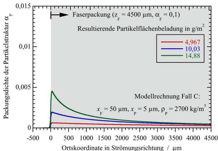
Bild 2: Ortsverteilung aller abgeschiedenen Partikeln zu drei ausgewählten, resultierenden Partikelflächenbelastungen, ca. 5, 10 und 15  $\text{g/m}^2$ , für die **Modellrechnung zu Fall C**, dargestellt in Form von der auf den gesamten Raum bezogenen lokalen Packungsdichte der Partikelstruktur als Funktion der Ortskoordinate in Strömungsrichtung.
